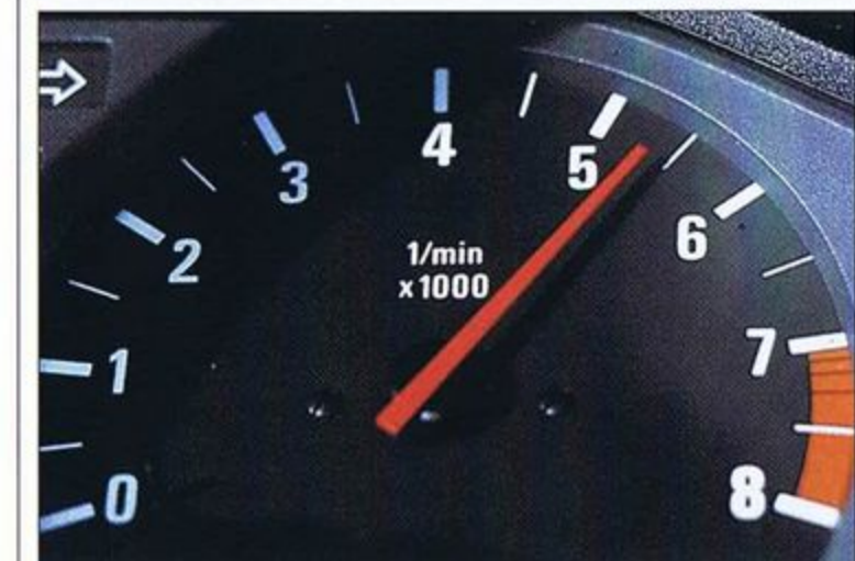
Um Schäden vorzu-beugen, unterbricht der Drehzahlbegren-zer den Schub. knapp über 7000/min
